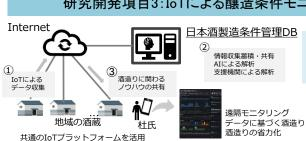
作業負荷軽減と醸造の安定 化を目指した現実的で安価 なシステムの構築実証
