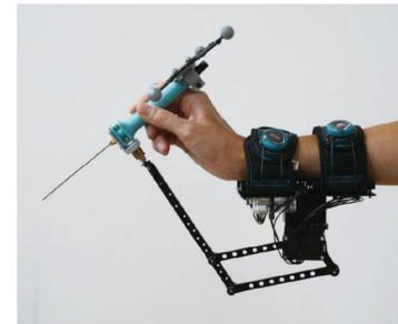
図5 道具を用いた運動支援のための装着型システム
