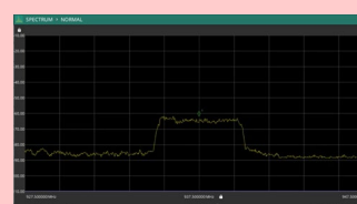
図3 北海道で観測した試験衛星からのLTEダウンリンク信号(Band-8)
