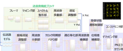
図2-a-1：仮想光チャネル生成・検出回路モデル
