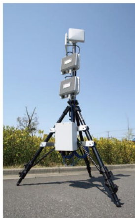
三脚による仮設置
