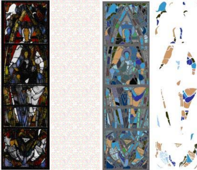
(彩色試料の可視光画像)(左図試料のTHz 疑似カラー表示、白部分の抽出)
