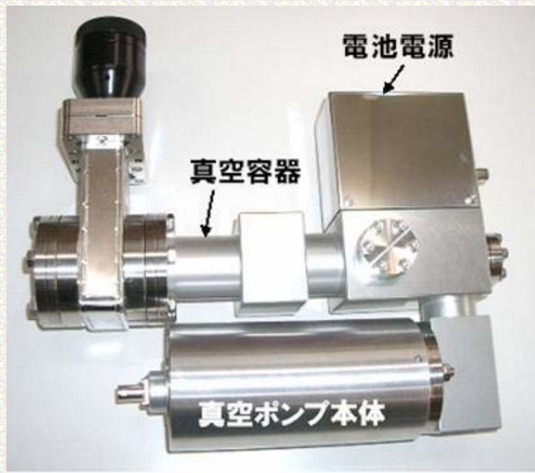
写真1. 開発した超コンパクトイオン真空ポンプと真空容器とを組み合わせた装置全体の外観
