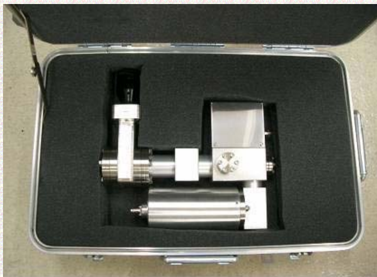
写真2. 搬送を目的としたスーツケースに収納した超コンパクト真空ポンプ類一式
