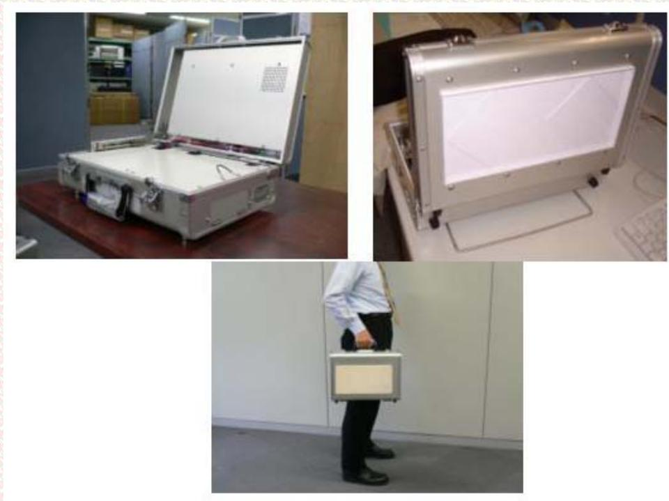
図1 小型ポータブル32GHz帯ミリ波無線ターミナルの外観
