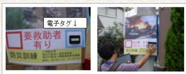
図1-2: 実験に使用する看板(左)および電子タグを用いた被災情報収集システムの使用イメージ(右)
