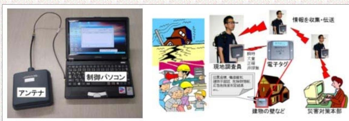
図1-1: 被災情報収集用電子タグ書き込み・読み取り端末(左)および使用イメージ(右)
