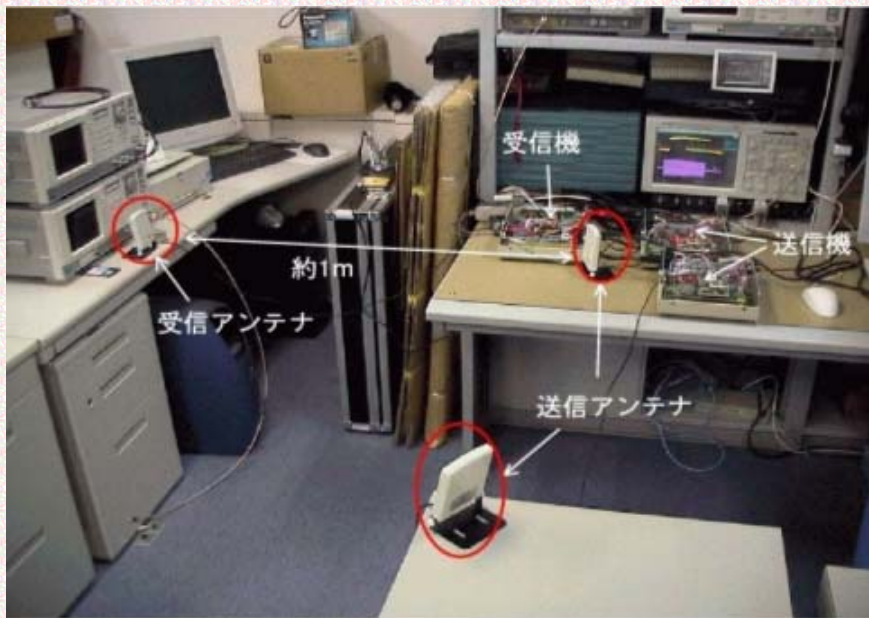
図3. カオスCDMAの無線通信実験成功の様子。 様々な外部ノイズがある実環境下での実験。 (NICTにある株式会社カオスウェアの研究室内)
