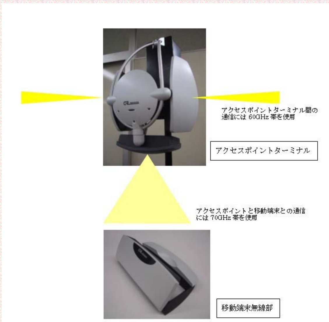
図3 アクセスポイントターミナル(左:サイズ325 x 430 x 161 mm)と移動端末無線部(右:サイズ 127 x 212 x 38 mm)の外観(移動端末無線部はモデムを経由してノートPCに接続されます)
