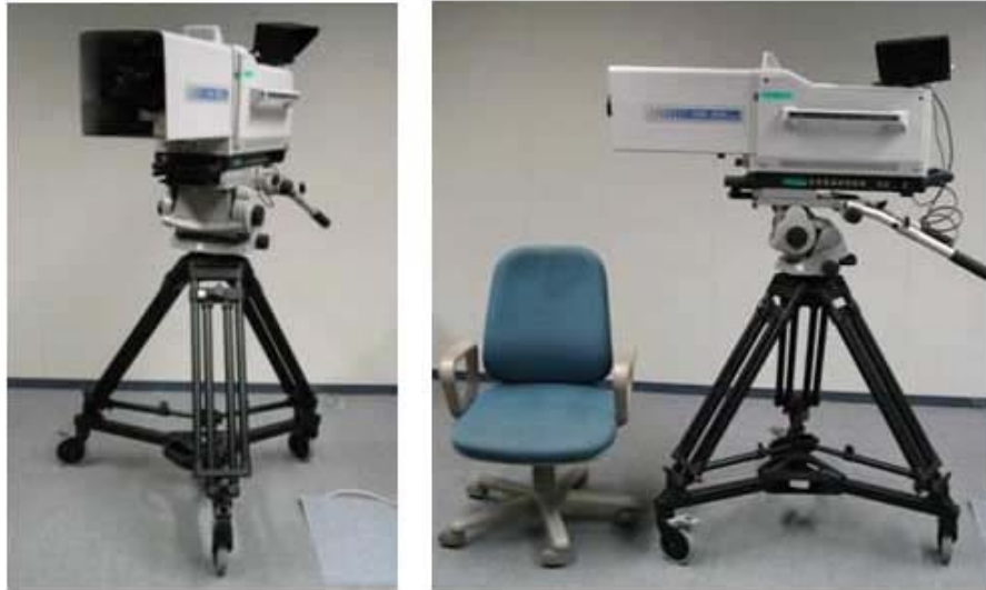
800万画素超高精細CMOS動画像カメラ
