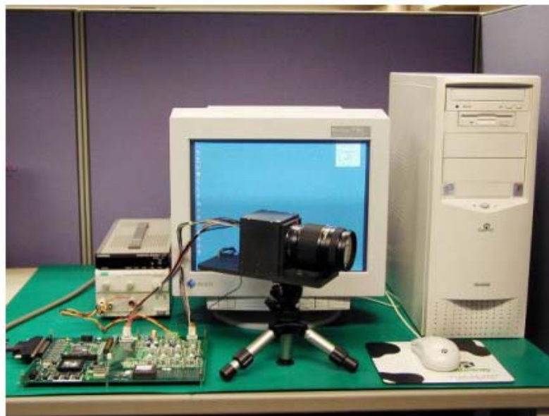
3,840 × 2,048画素CMOS超高精細動画カメラ
