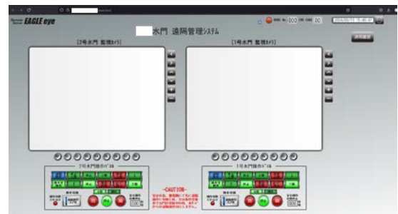
① 感染 IoT 機器特定システムで発見した事例 水門制御システムの管理機器（PLC）の感染事例の特定
