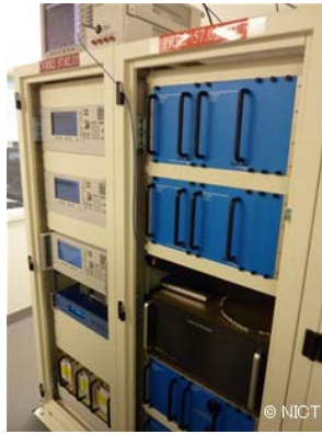
図1 アルマシステムに接続された基準信号発生装置（中央黒い機器が今回の装置）
