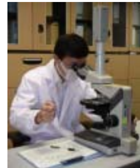
PCM測定 測定結果を出すまでに数日かかる 計数作業により結果にばらつき
