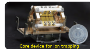
In + イオントラップ光時計 Optical clock based on trapped In + ions
