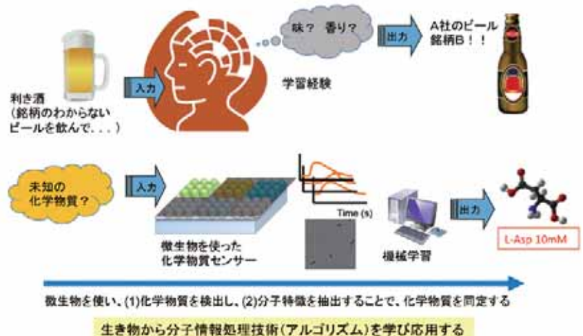
図3 細胞を使った化学物質種同定の概念図 例えば、利き酒を細胞のレベルにまで落とし込むことに相当する。利き酒では、ヒトは学習経験を使って、飲んだお酒の銘柄を推定する。微生物を使った化学物質種の同定では、訓練用データと機械学習を使って、未知入力を推定する。生き物から分子情報処理の技術を学び、テクノロジーとして応用する。
