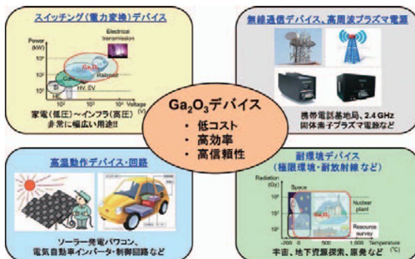
図1 Ga 2 O 3 デバイスの実用領域 ここに示したのは想定されるGa 2 O 3 デバイスの代表的な実用分野である。低コスト、高効率、高信頼性などその特徴から、いずれの分野でもその高い性能が期待される。
