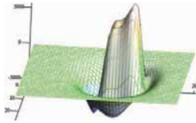
図5 bRを利用した新たな視覚機能をもつセンサで右へ移動するオブジェクトを見たときのシミュレーション。進行方向が強調され、移動方向が瞬時に認識できる。(Simulation by Prof. Aida and Dr. Katagiri)
