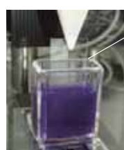
図3 ディップコート法。ゆっくり引き上げるほど薄い膜になる。(紫色はbR溶液)
