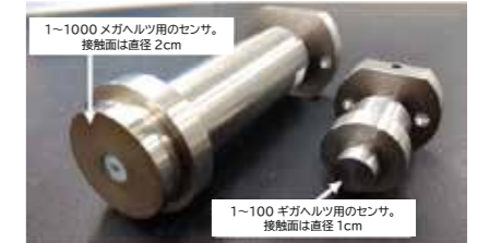
NICTが開発したセンサプローブの接触面を生体組織に接触させることで、電気定数を測定する。
