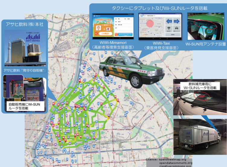
飲料自動販売機・タクシー等へのWi-SUNデバイス搭載の様子と、これらデバイス間のつながりによる地域ネットワーク構築の様子
