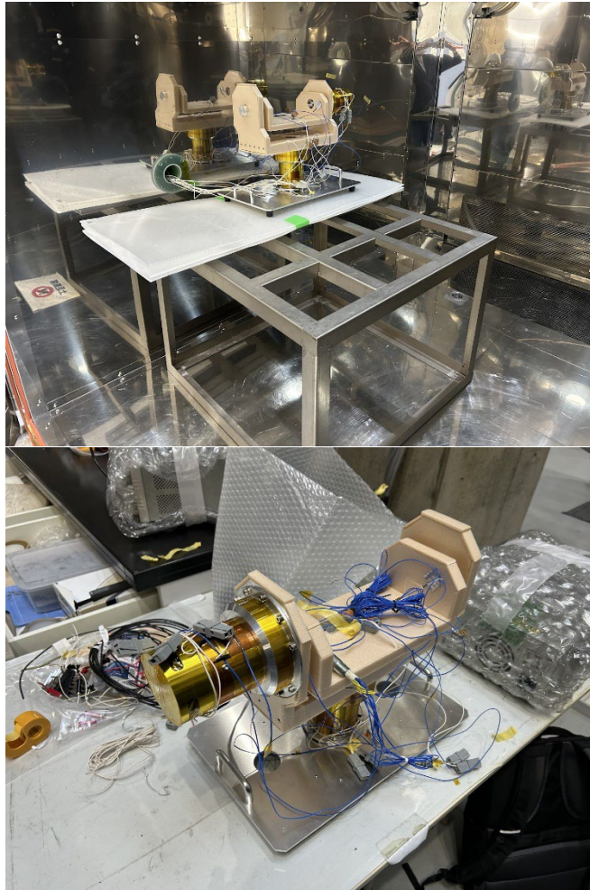
図2. HAPS用光追尾システムBBM
