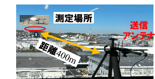
ドローンを用いたKファクタ測定(市街地)
