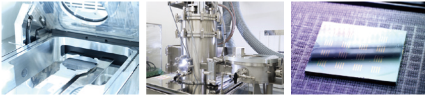
図1 シリコン微細加工装置(左)や原子層堆積装置(中央)などを駆使した有機無機ハイブリッドプロセスにより超高速小型変調器(右)などの革新的な光制御デバイスを開発しています。
