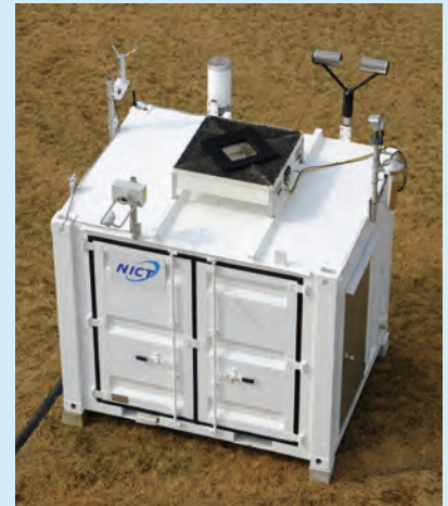
図5 PAWR, CDL の地上検証のための地上降水観測システム
