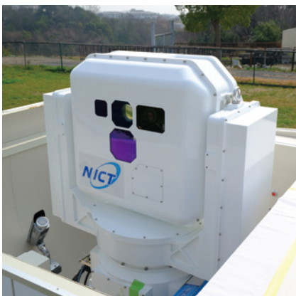
図5 光空間通信設備神戸小型局の地上局光学系およびジンバル(左)、航空機搭載側ターミナル光学系およびジンバル(右)。(11ページの記事参照)
