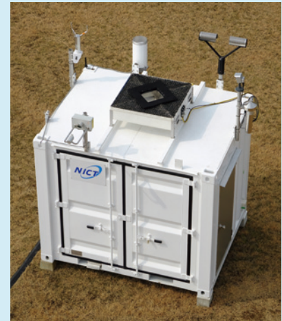
図5 PAWR, CDLの地上検証のための地上降水観測システム
