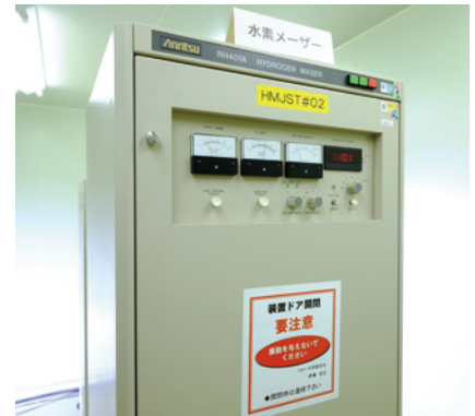
図4 セシウム原子時計(左)と水素メーザー(右) 日本標準時副局にあるセシウム原子時計の内部(手前にあるのが原子振動数測定チューブ)。水素メーザーは実信号源として使用されている。(10ページの記事参照)
