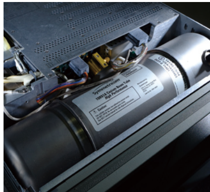
図4 セシウム原子時計(左)と水素メーザー(右) 日本標準時副局にあるセシウム原子時計の内部(手前にあるのが原子振動数測定チューブ)。水素メーザーは実信号源として使用されている。(10ページの記事参照)
