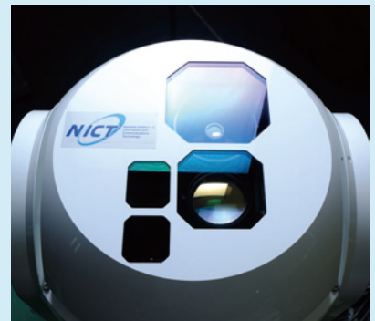
図2 光空間通信設備神戸小型局の地上局光学系およびジンバル(上)、航空機搭載側ターミナル光学系およびジンバル(下)。
