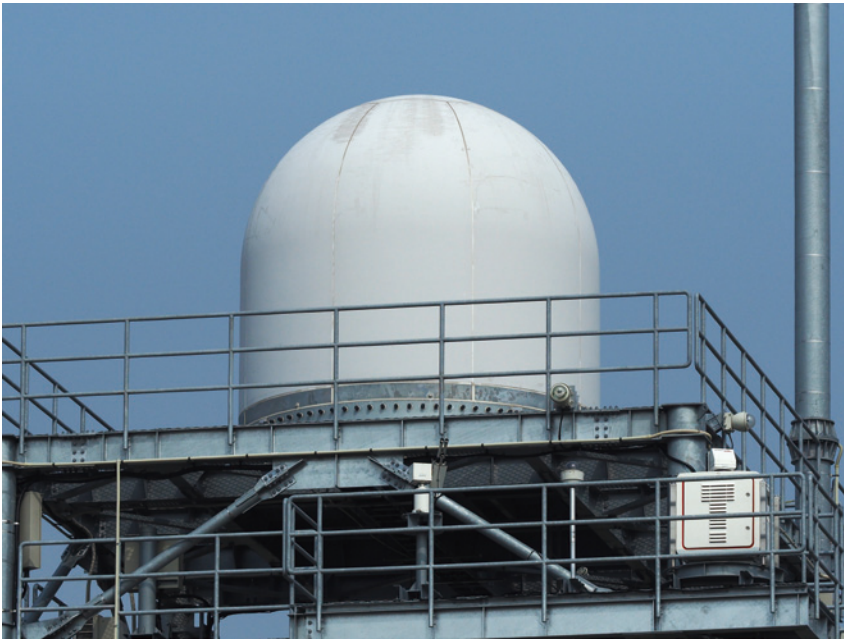
図3 フェイズドアレイ気象レーダ(上)と地上降雨観測システム(左)
