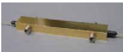
LiNbO 3 マッハツェンダ光変調器の外観
