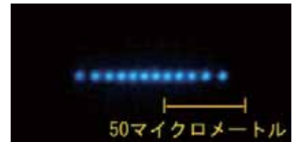
図2 イオントラップ内でレーザー冷却により一列に配置した12個のカルシウムイオン（ \text{Ca}^+ ）。
